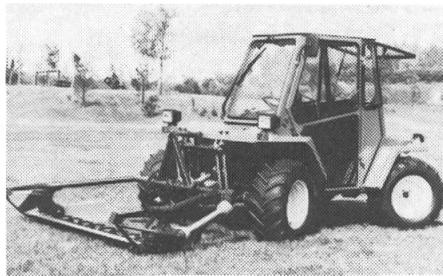
Der neue Metrac 3003 verfügt über den 3-Zylinder Kubota Dieselmotor mit 30,5 PS Leistung und ist mit dem bewährten Doppelmesser-Mähwerk ausstattbar. Die hydrostatische Allradlenkung, das 8-Gang Gruppenwendegetriebe, die grosse Terra-Bereifung und das Heckhubwerk auf Wunsch sind die Vorteile der bewährten 3003-Baureihe.
