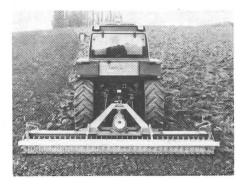
Diese neue Serie der Kuhn-Kreiseleggen ist bestimmt für schwere und steinige Böden. Sie ist in den Arbeitsbreiten von 2,5 m bis 4,5 m lieferbar und eignet sich für Traktoren von 80 PS bis 180 PS.
