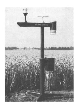
sicht über die momentane Wetterlage in der unmittelbaren Umgebung. Die Wetterstation ist mit elektronischen Fühlern ausgestattet, die die Lufttemperatur, die Niederschlagsmenge, die Bodentemperatur, die Windrichtung und die Windgeschwindigkeit messen.
