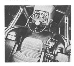
Die neue Baureihe FII ist mit einer neuen Super-Komfort-Kabine 75 dBA (FAT-getestet) ausgerüstet. Dank besserer Rundsicht, hängenden Pedalen, Seitenschaltung rechts und moderner Kommando-Zentrale bieten diese Traktoren optimalen Komfort und Sicherheit. Lastschaltbare Halbgänge und Allrad-Antrieb sind durch Knopfdruck einund zuschaltbar.
