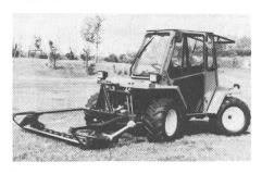
Der neue Metrac 3003 verfügt über den 3-Zylinder Kubota Dieselmotor mit 30,5 PS Leistung und ist mit dem bewährten Doppelmesser-Mähwerk ausstattbar. Die hydrostatische Allradlenkung, das 8-Gang Gruppenwendegetriebe, die grosse Terra-Bereifung und das Heckhubwerk auf Wunsch sind die Vorzüge der bewährten 3003-Baureihe.
