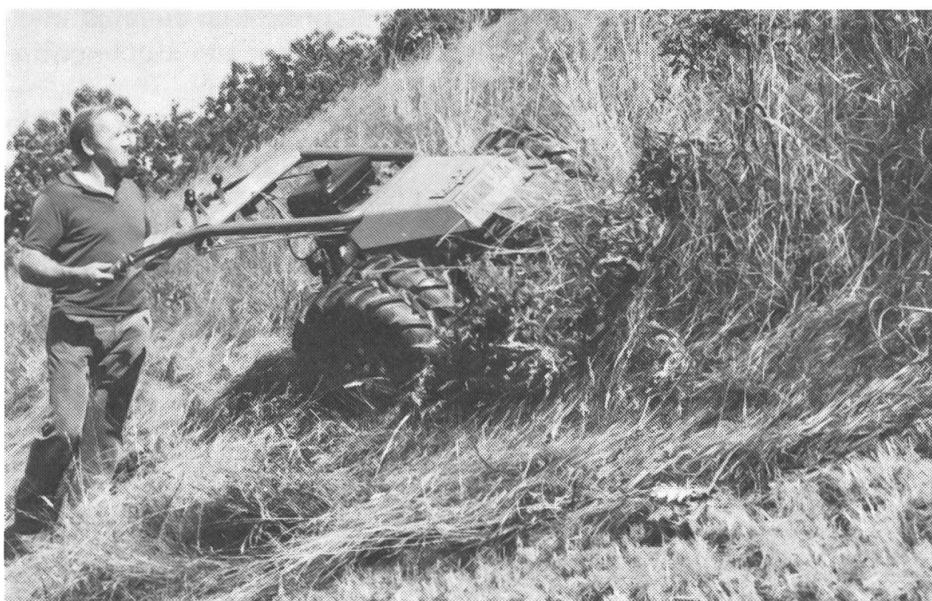
Durch das Schwenken des Holmes wird beim RAPID-406-Breitspürmäher die Einzelradbremse angesprochen, was den Kraftaufwand bei der Korrektur der Fahrrichtung reduziert.
