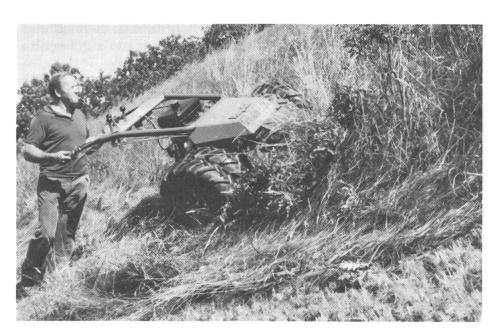
Durch das Schwenken des Holmes wird beim RAPID-406-Breitspurmäher die Einzelradbremse angesprochen, was den Kraftaufwand bei der Korrektur der Fahrrichtung reduziert.
