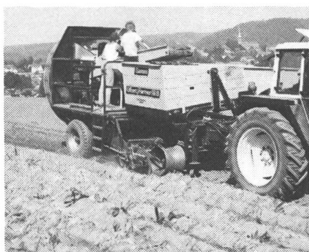
SAMRO Offset – ein neuer Seitenroller für Kartoffeln. Auch der Antrieb der Siebkette und des Verlesetisches erfolgt hydraulisch und ist stufenlos regelbar.
