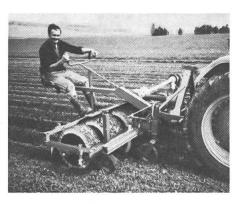
Diese Reihenhackbürste der Firma Bärtschi entspricht dem Wunsch nach weniger Chemie. Die Verwendung neuer Werkstoffe ermöglicht dieses Arbeitsverfahren.
