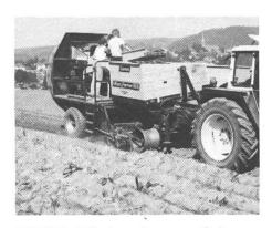
SAMRO Offset – ein neuer Seitenroder für Kartoffeln. Auch der Antrieb der Siebkette und des Verlesetisches erfolgt hydraulisch und ist stufenlos regelbar.
