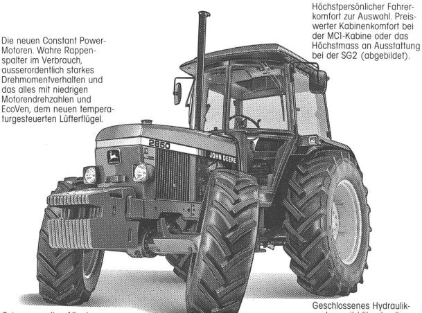
Extrem wendige Allrad-Traktoren durch den unvergleichlichen 12-Grad-Nachlaufwinkel. Auf Fingertip unter Last schaltbar. Automatisches Selbstsperrdifferential.
