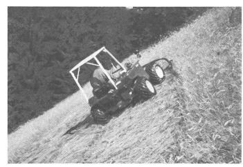
Abb. 1a und 1b: Beim Mähen mit dem Motormäher oder Zweiachsmäher kommt der Unterschied zwischen mässiger und starker Mechanisierung recht deutlich zum Ausdruck. Stellt man auf die Betriebsgrösse ab, dann ist der Motormäher im Bergbetrieb von 12 GVE, der Zweiachsmäher im 28-GVE-Betrieb als angepasste Lösung zu betrachten.
