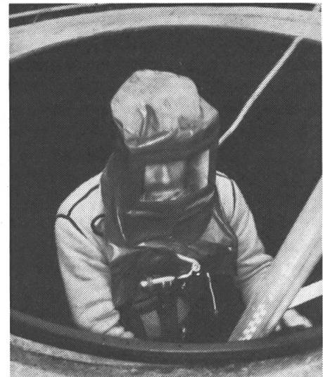
*Die Handhabung ist denkbar einfach: Die in einer Alufolie luft- und feuchtigkeitsdicht eingesiegelte Fluchthaube über den Kopf ziehen und Sauerstoffzufuhr (max. 8 Minuten) durch die Auslöseschnur starten.*
