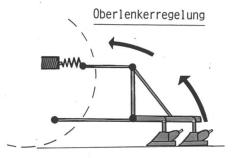
Die Oberlenkerregelung reagiert auf die <u>Kippneigung</u> des angebauten Gerätes.
