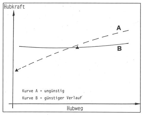
Abb. 4: Hubkraft. Die durchgehende Hubkraft wird über den ganzen Hubweg, von unten bis oben erbracht.
