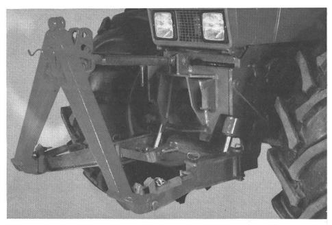
Abb. 5: Der frontseitige Dreipunktanbau entspricht in seinen Abmessungen weitgehend demjenigen des Heckanbaues. Achtung: Bei der Zapfwelle bestehen bezüglich **Drehzahl und Drehrichtung unterschiedliche Ausführungen.**
