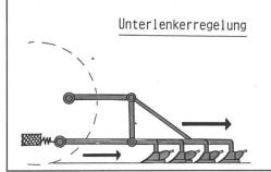
Die Unterlenkerregelung reagiert auf <u>horizontal auftretende Kräfte</u> an den unteren Lenkern.
