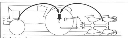
Ein Teil des Gerätegewichtes überträgt sich auf die Traktorhinterachse, dadurch erhöht sich das Zugvermögen der Hinterräder.
