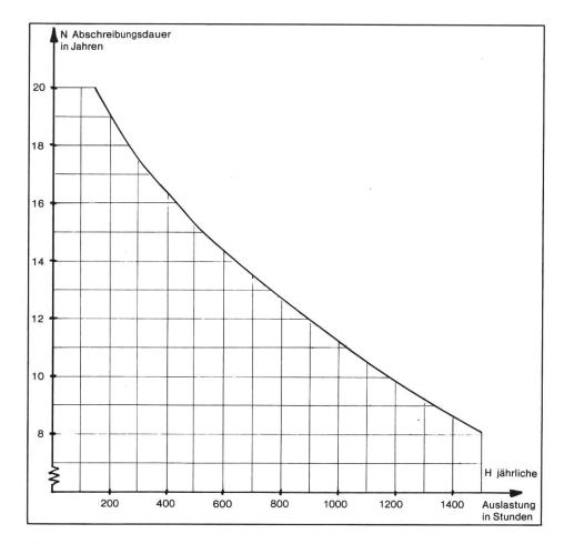
Abb. 1: Mutmassliche Lebensdauer und Vorschlag zur Festlegung der Abschreibungsdauer bei Traktoren mit unterschiedlicher jährlicher Auslastung.
