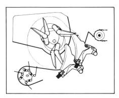
Supermatic-Schneid- und Ladesystem Messer als Schnellwechsel-Einheiten Vollautomatische Messerrückstellung nach Fremdkörperdurchgang
