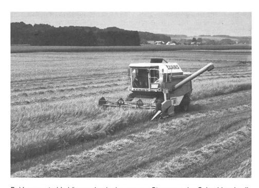
Bei Lagergetreide können durch eine genaue Steuerung des Schneidwerks die Ernteverluste reduziert werden.
