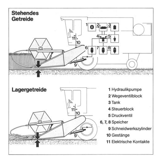
Aufbau einer Schneidwerks-Steuerung.
