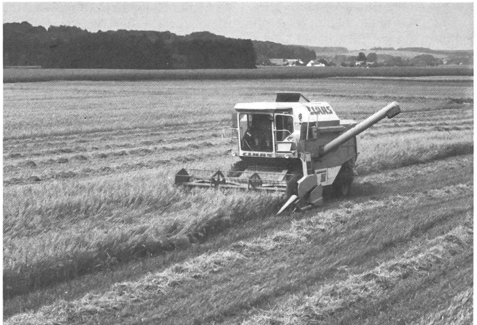
Bei Lagergetreide können durch eine genaue Steuerung des Schneidwerks die Ernteverluste reduziert werden.
