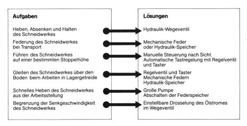
Aufgaben der Hydraulik für die Steuerung und Führung eines Schneidwerkes.
