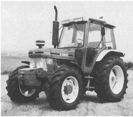
scheiden sich im wesentlichen auch durch die neue Super-Deluxe-Kabine mit flachem Boden, hängenden Pedalen, Seitenschaltung, 9-fach verstellbarem Fahrersitz und vor allem durch ergonomisches Design und den niedrigen Lärmwert am Fahrer-Ohr von 75 dBA (FAT geprüft). Die Bedienungshebel für Hydraulik, Zapfwelle und Zusatzsteuerventile sind auf einer Konsole rechts neben dem Fahrersitz handlich angeordnet. Ford F II, die ruhigen Schwerarbeiter.
