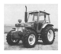
scheiden sich im wesentlichen auch durch die neue Super-Deluxe-Kabine mit flachem Boden, hängenden Pedalen, Seitenschaltung, 9-fach verstellbarem Fahrersitz und vor allem durch ergonomisches Design und den niedrigen Lärmwert am Fahrer-Ohr von 75 dBA (FAT geprüft). Die Bedienungshebel für Hydraulik, Zapfwelle und Zusatzsteuerventile sind auf einer Konsole rechts neben dem Fahrersitz handlich angeordnet. Ford F II, die ruhigen Schwerarbeiter.
