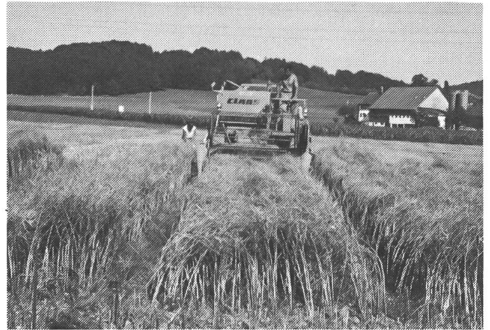
Abb. 5: Die Ernte der Versuchsflächen erfolgte mit einem Parzellenmähdrescher mit 2,1 m Mähbreite nach einer vorgängigen Trennung der Parzellenränder von Hand im Getreide (links) oder bei Raps durch eine Herbizidspritzung im Herbst.
