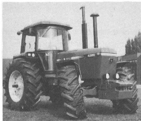
Auf der Agritechnica 85 stellte John Deere erstmals seinen neuen Traktor 4350 mit 103 kW (140 PS) vor, der den Traktor 4230S ersetzen soll. Diese Maschine ist durch eine Reihe von Weiterentwicklungen gekennzeichnet, die ihre Leistungsfähigkeit erhöhen.
