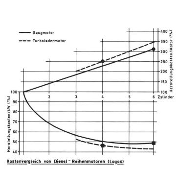
3: Bei vergleichbarer Leistung liegen die Herstellungskosten je Motor, wie auch die Kosten pro Kilowatt (kW) beim Motor mit Abgasturbolader günstiger als beim Saugmotor.
