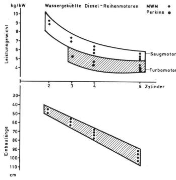
4: Vergleich von Leistungsgewicht und Einbaulänge/ Zylinder wassergekühlter Diesel-Reihenmotoren.
