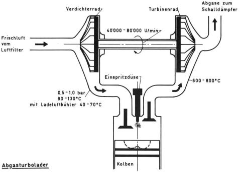
2: Die heissen Abgase treiben das Turbinenrad an, bevor sie durch den Auspuff entweichen. Das auf der gleichen Welle sitzende Verdichterrad saugt Frischluft vom Luftfilter an und presst sie mit einem Überdruck von 0,5 bis 1,0 bar in die Zylinder.
