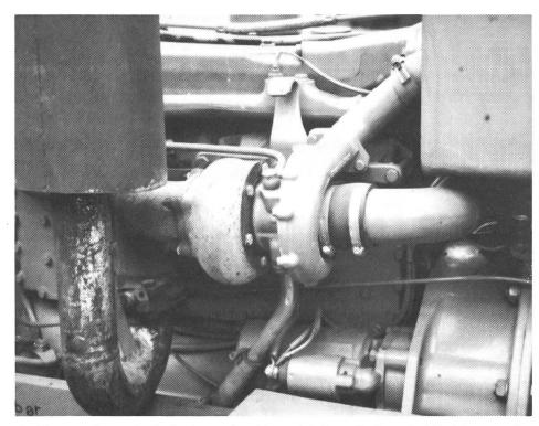
1: Die zunehmende Bedeutung der Abgas-Turboaufladung bei Traktorenmotoren hängt vor allem, einerseits mit den kleineren Motorabmessungen, dem geringeren Motorgewicht sowie den geringeren Herstellungskosten bei vergleichbarer Leistung zusammen und anderseits mit den bereits bestehenden und in Zukunft schärferen Umweltschutzbestimmungen bezüglich Lärm und Abgase.
