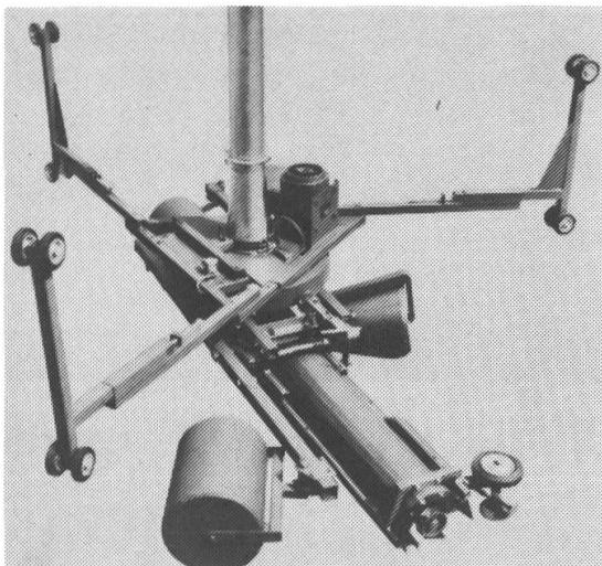
Mühelose Silageentnahme und Einsparung an Arbeitszeit mit der EPPEL Silofräse. Höchstleistung und Funktions sicherheit sind neben dem geringen Kraftbedarf ihre besonderen Stärken.
