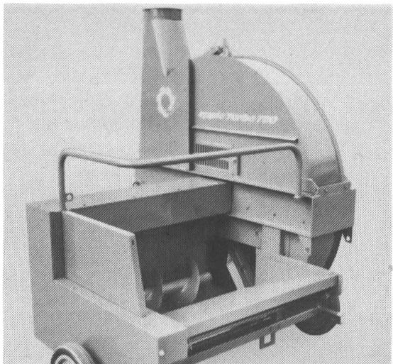
Für die schlagkräftige Silobefüllung sorgen die Siliergebläse EPPEL Turbo.
