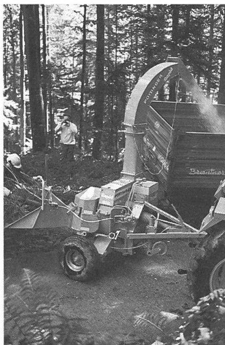
und wartungsarm ausgelegt. Den Antrieb der Einzugswalzen (Zwangseinzug mit Vor-, Rücklauf und Stop) übernimmt eine eigene Hydraulikanlage. Mit dem Sicherheitsschaltbügel am Einzugstrichter wird besonders Wert auf Bedienungssicherheit gelegt.
