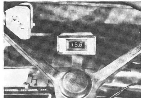
der Zehntel km angezeigt, dh. die Geschwindigkeit wird sehr genau erfasst. Bei Geschwindigkeiten über 7 km/Std. nimmt der Anzeigesprung progressiv zu, beginnend mit 0,2 bis ca. 0,8 bei einer Geschwindigkeit von 30 km/Std. Durch diese Massnahme wird verhindert, dass bei grösseren Geschwindigkeiten die hinterste Stelle der Anzeige dauernd wechselt.
