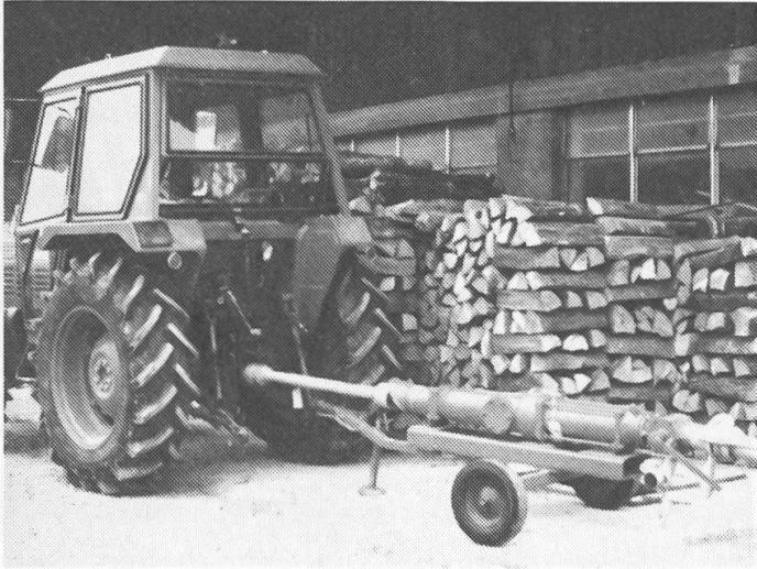
Abb. 2: Um die hohe Antriebsleistung sicherzustellen, werden leistungsfähige Pumpen oft über die Zapfwelle angetrieben.
