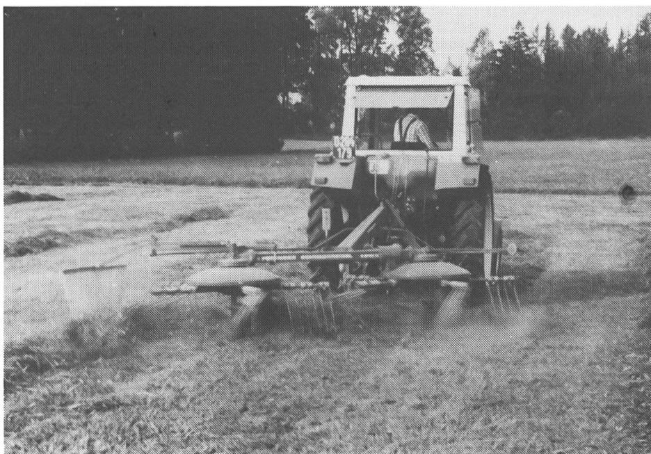
Abb. 1: Tief eingestellte Maschinen vermindern zwar die Verluste, führen aber unweigerlich zu verschmutztem Futter.
