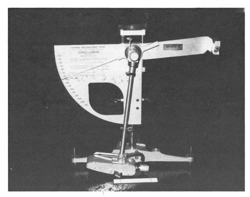
Abb. 1: Skid-Resistance-Tester (SRT-Gerät).
