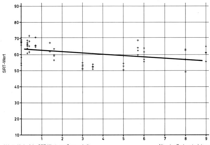
Abb. 5: Verlauf der SRT-Werte von Gussasphalt.
