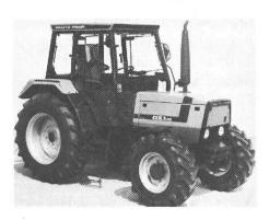
Der neue DX 3.60-Traktor ist eine Allrad-Maschine aus der beliebten DX 3-Reihe. Mittig geführter Allrad-Antrieb mit besonderem Wickelschutz und bereits im Basisumfang des Selbstsperrdifferential OPTI-BLOC sowie die Bereifung 14.5R20 vorn und 16.9R30 hinten sorgen dafür, dass auch unter schwierigen Bedingungen die Leistung von 48 kW (65 PS) des robusten, durchzugstarken, luftgekühlten 4-Zylindermotors voll in Zugleistung umgesetzt werden kann.
