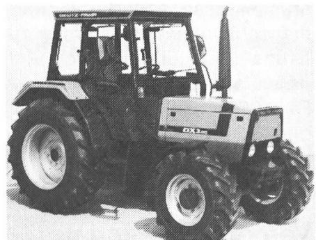
Der neue DX 3.60-Traktor ist eine Allrad-Maschine aus der beliebten DX 3-Reihe. Mittig geführter Allrad-Antrieb mit besonderem Wickelschutz und bereits im Basisumfang des Selbstsperrdifferential OPTI-BLOC sowie die Bereifung 14.5R20 vorn und 16.9R30 hinten sorgen dafür, dass auch unter schwierigen Bedingungen die Leistung von 48 kW (65 PS) des robusten, durchzugstarken, luftgekühlten 4-Zylindermotors voll in Zugleistung umgesetzt werden kann.
