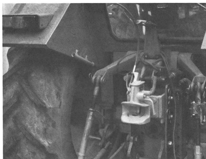
9: Die automatische Anhängerkupplung mit Fernbedienung ermöglicht das An- und Abkuppeln vom Fahrersitz aus auch bei geschlossener Fahrerkabine.
