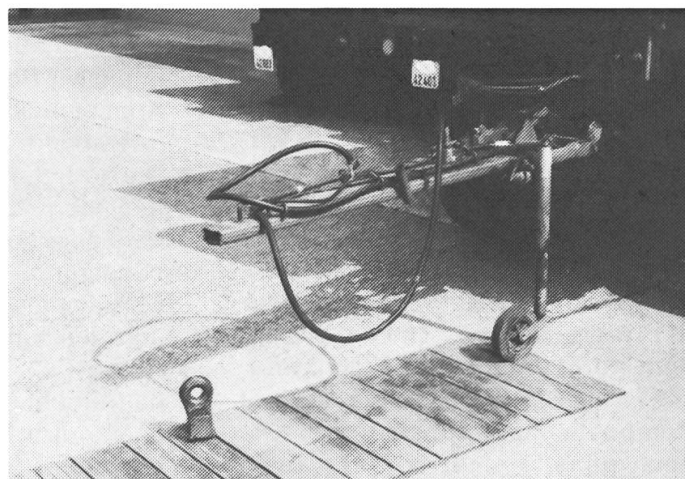
Abb. 11+ 12: Zug- und Stossvorrichtungen mit zu schmaler Öffnung beschädigen bei starker Abwinklung die Anhängerdeichsel.
