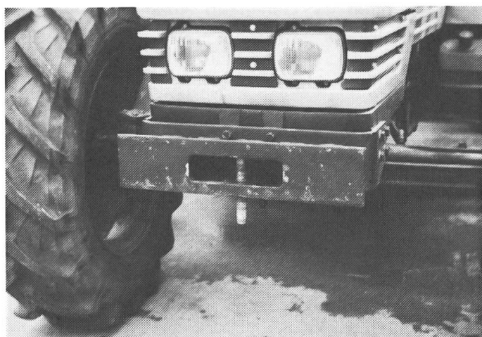
Abb. 11+ 12: Zug- und Stossvorrichtungen mit zu schmaler Öffnung beschädigen bei starker Abwinklung die Anhängerdeichsel.
