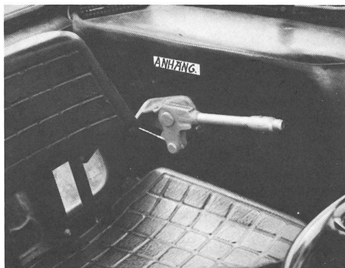
10: Der Fernbedienungshebel soll gegen unbeabsichtigtes Betätigen gesichert und gut beschriftet sein.
