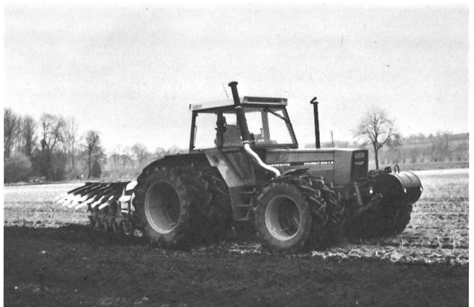
Geht die Entwicklung in diese Richtung? – Die Traktorräder laufen ausserhalb der Pflugfurche. Angepasste Konstruktionen für kleinere Pflugmodelle sind noch ausstehend. (Foto: H. Rechsteiner, GVS)
