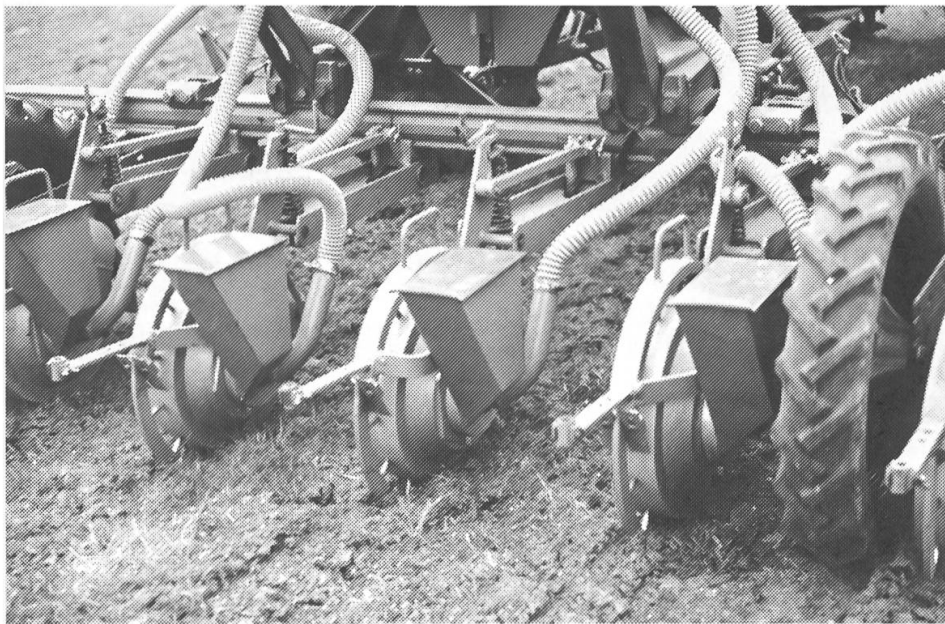
Mit angepasster Sätechnik kann auch eine anspruchsvolle Zuckerrübenkultur ohne Pflugeinsatz erfolgreich angebaut werden, wie dies durch einen Grossflächenversuch mit einer Sästempelmaschine gezeigt wurde.
