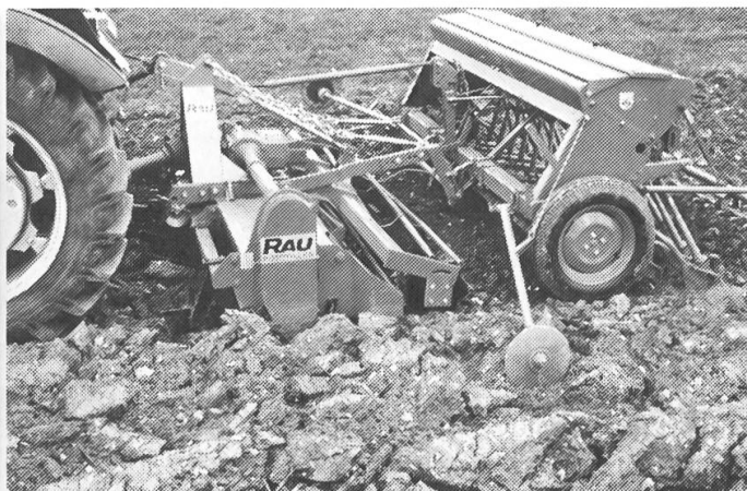
Mit einer Gerätekombination «Zinkenrotor plus Sämaschine» kann das Feld nach der Pflugfurche in einem Durchgang bestellt werden.
