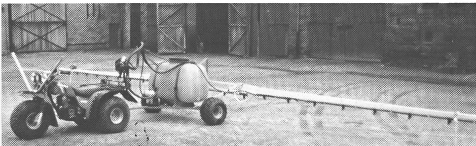
Durch die Wahl grossvolumiger Reifen kann der Reifendruck reduziert und die Verdichtung in der Ackerkrume herabgesetzt werden.
