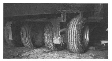
Pendelachse. – Nach heutigem Stand der Technik die beste Lösung zur Verminderung des Bodendrucks. Der grössere Rollwiderstand der Pendelachsfahrwerke gegenüber der Tandemachse erfordert eine höhere Zugkraft.
