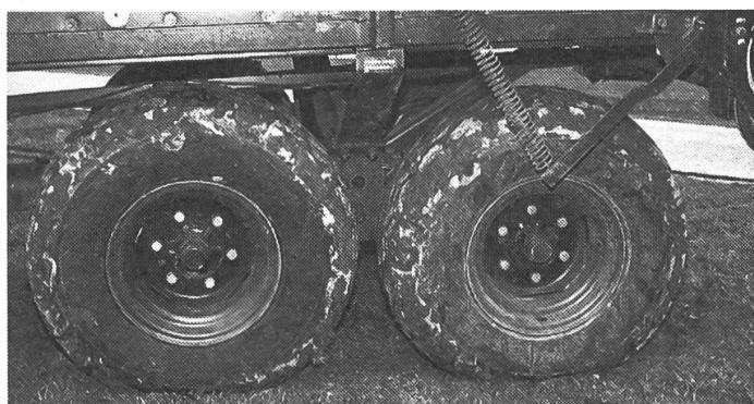
**Tandemachse.** Nicht die optimale Lösung, da durch das zweimalige Befahren der gleichen Spur der Boden auch in tieferen Schichten verdichtet wird. Bei Kurvenfahrten treten starke Radseitenkräfte auf, die Bodenschäden (Verletzung der Grasnarbe, Verschmieren des Bodens) oder hohen Reifenverschleiss bei Strassenfahrten bewirken.
