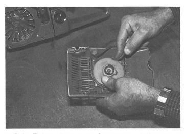
3: Beim Einbau eines neuen Starterseils wird die Rückzugsfeder gespannnt, ohne dass das Seil aufgewickelt wird. Das Seil wird dazu in der Aussparung am Rand der Seilrolle mitgeführt.
