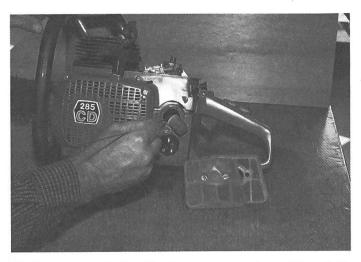
2: Eine regelmässige Reinigung von Luft- und Benzinfilter sind Voraussetzung für einen störungsfreien Betrieb der Motorsäge.
