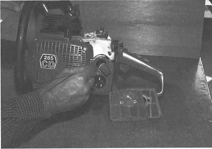
2: Eine regelmässige Reinigung von Luft- und Benzinfilter sind Voraussetzung für einen störungsfreien Betrieb der Motorsäge.
