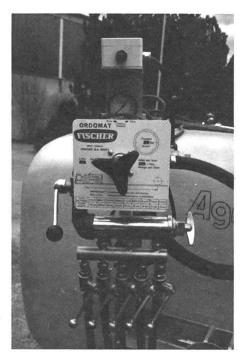
Gleichdruckarmaturen erlauben eine exakte Dosierung auch bei reduzierten Brühemengen.
