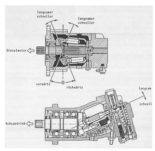
4: Hydrostatischer Antrieb des TT88: Schrägscheibenpumpe und Schrägachsmotor.
