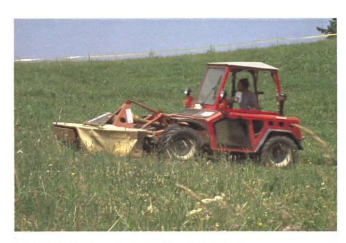
1: TT88 beim Einsatz als Zweiachsmäher mit Kreiselmäher (Arbeitsbreite: 2,15 m)
