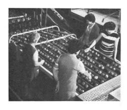
nicht mehr von Hand entfernt werden müssen. Darüber hinaus sorgt die elektronische Sortierung für die automatische Aufteilung auf die verschiedenen Ausgänge, so dass diese unabhängig von den prozentualen Anteilen der verschiedenen Güteklassen nicht blockiert werden. Dadurch wird gleichzeitig die Qualität der Früchte besser gewahrt.
