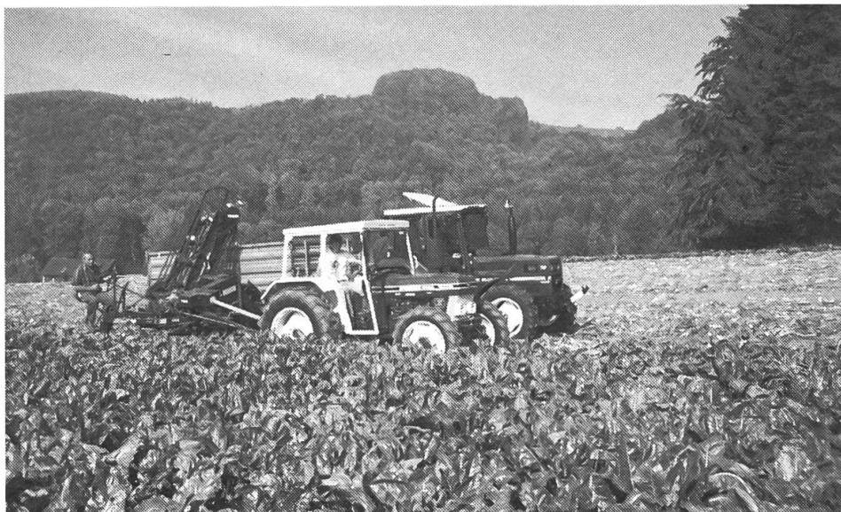
4: Die einfacheren Vollernter arbeiten nach dem Überladeprinzip.
