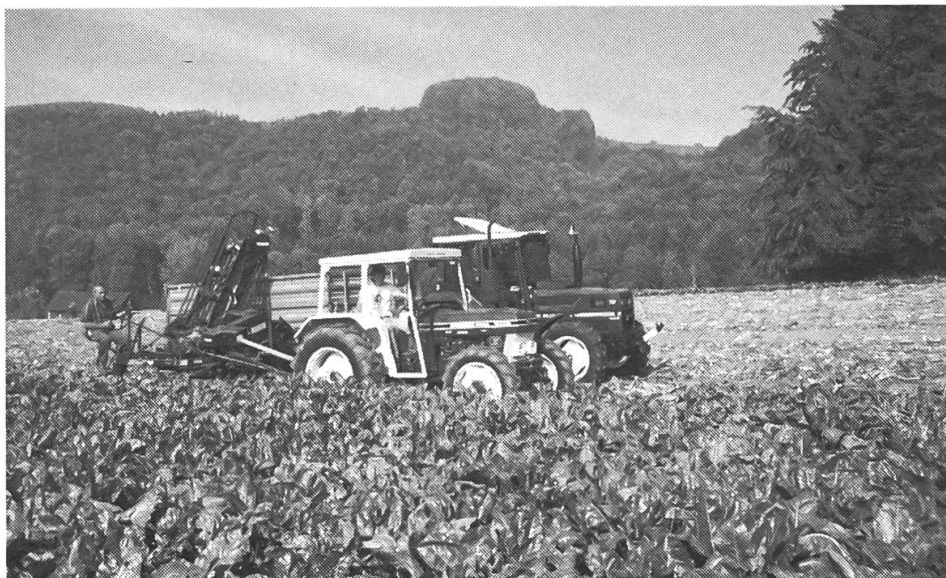
4: Die einfacheren Vollernter arbeiten nach dem Überladeprinzip.
