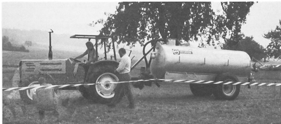
Schlupfmessung bei Traktor mit Druckfass.
