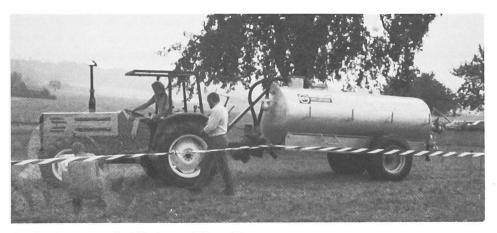
Schlupfmessung bei Traktor mit Druckfass.
