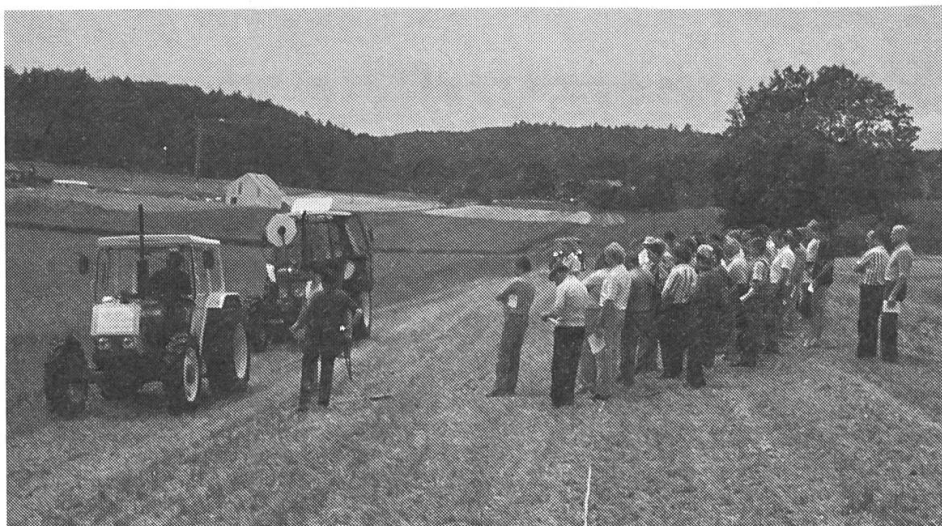
1: Schlupfmessung im Feld. – Trotz absolut trockenem Boden wurde je nach Bereifung, zum Teil erheblicher Schlupf gemessen.
