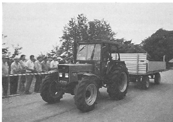
4: Daran schloss eine eindrückliche Bremsdemonstration mit verschiedenen Gefährten an. Hier: Vollbremsung ohne eingeschalteten Allradantrieb.
