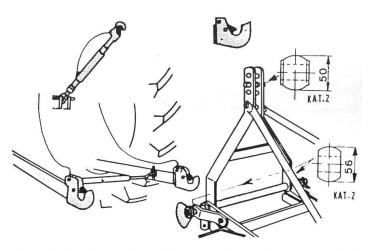
Abb. 3: Dreipunkt-Schnellkuppler (Zwei-Phasen-Kuppler) (Eingetragene Masse beziehen sich auf Kategorie 2).
