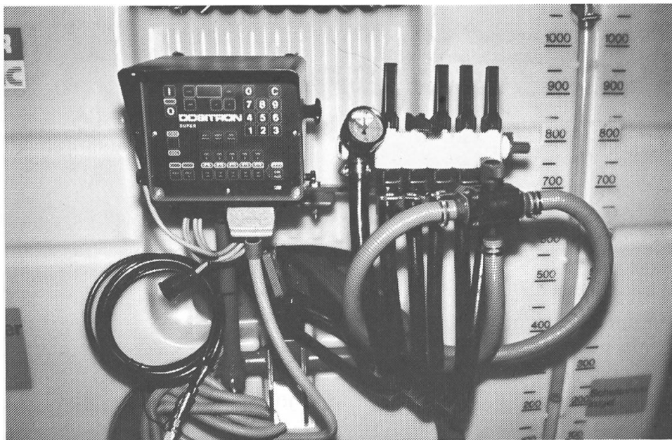
2: Elektronik beim Pflanzenschutz – Höhere Ausbringungsgenauigkeit und geringerer Brühmengenaufwand sind die Hauptziele.
