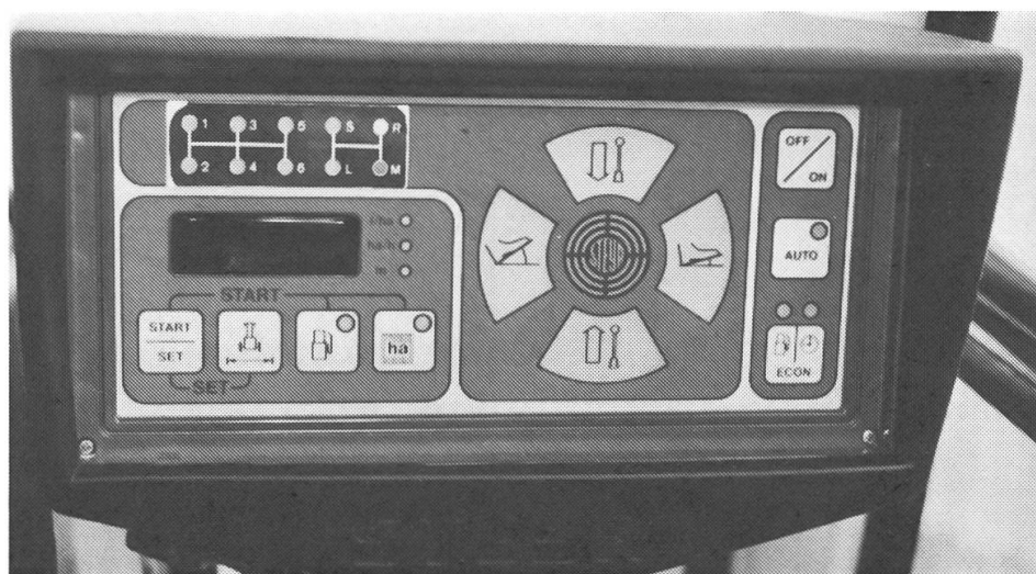
1: Elektronische Fahrerinformationssysteme sollen dem Fahrer eine optimale Auslastung des Traktors und dadurch Treibstoffeinsparungen erlauben.
