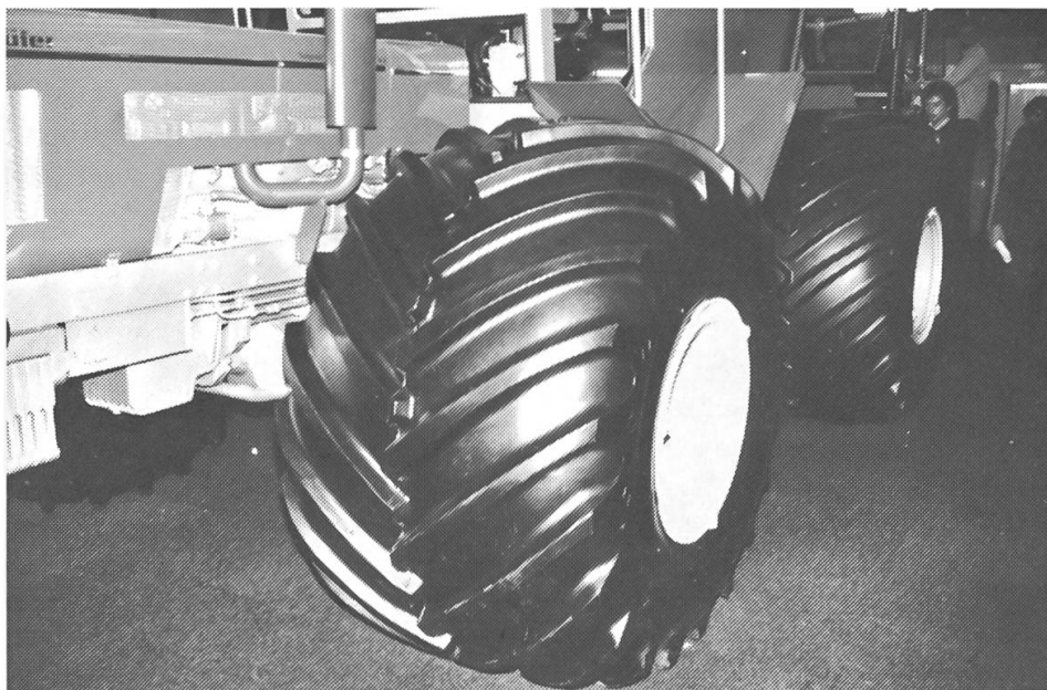
4: Bodenschonung: Breitreifen helfen den Bodendruck verringern.
