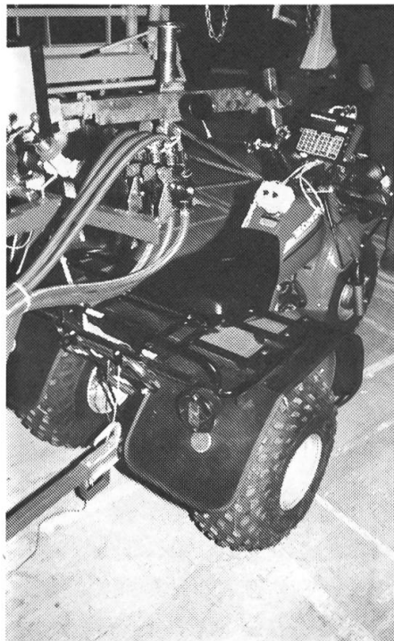
6: Bodenschonende Alternative: Motordreirad für Pflanzenschutzarbeiten.
