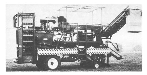
Von der französischen Firma Ateliers de Claire Fontaine wurde eine Tomatenerntemaschine entwickelt, die in der leistungsfähigsten Ausführung bis zu 24 Tonnen Tomaten pro Stunde pflückt.
