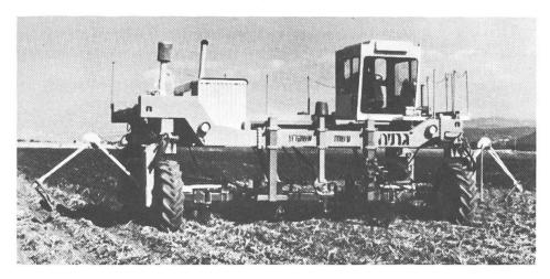
Ein Traktor nach einem vollständig neuen Konzept wurde in Israel entwickelt. Der «Merhav-Traktor FPU» hat eine Spurweite von 6 m. Die Bodenbearbeitungsgeräte werden nicht angehängt, sondern wie bei einem Geräteträger im Raum zwischen Vorder- und Hinterachse ange-
