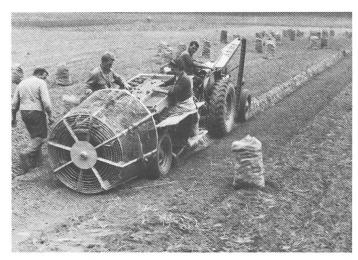
11: Durch den Einbau von Förderorganen in einen Siebkorb und einen daran anschliessenden Sortiertisch mit seitlich angeordneten Sitzbänken entstand der Sammelgraber.
