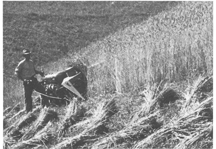
8: Stützradgeführter Frontbinder zum Einachstraktor.
