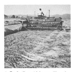
1: Zapfwellengetriebener Haspelrechen konventioneller Bauart.
