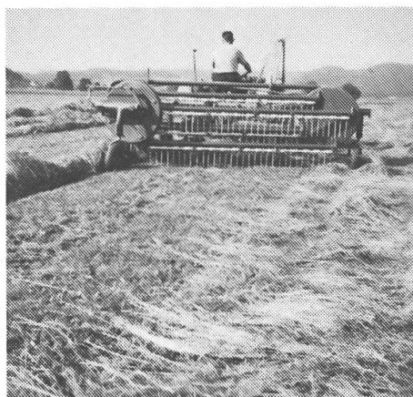
1: Zapfwellengetriebener Haspelrechen konventioneller Bauart.
