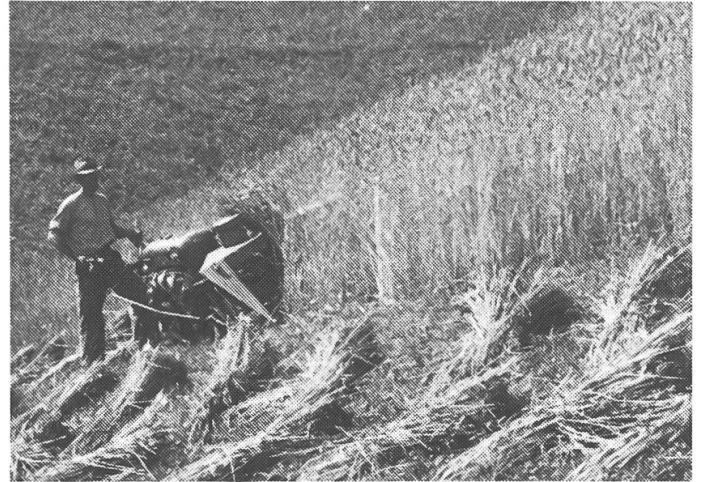
8: Stützradgeführter Frontbinder zum Einachstraktor.
