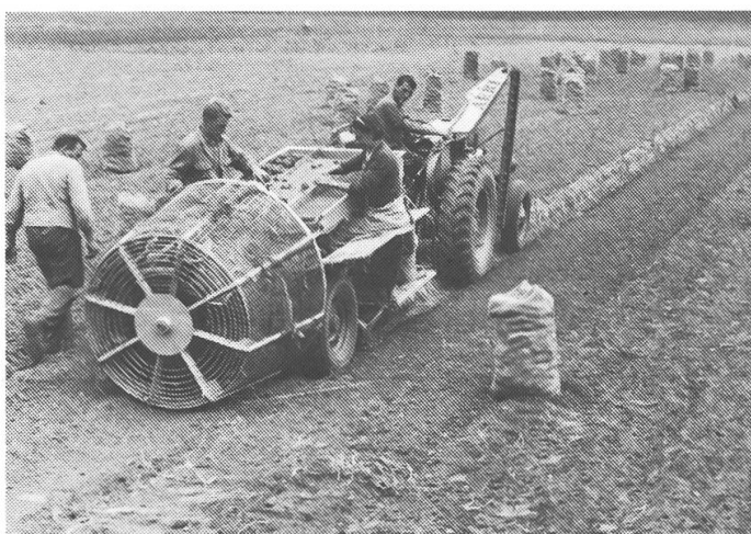
11: Durch den Einbau von Förderorganen in einen Siebkorb und einen daran anschliessenden Sortiertisch mit seitlich angeordneten Sitzbänken entstand der Sammelgraber.
