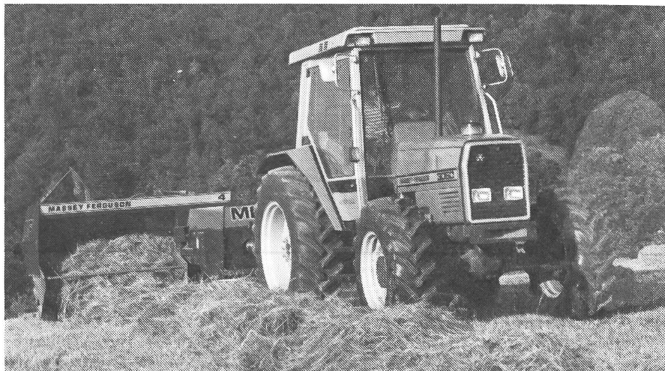
Der MF 3050 «autotronic» mit 68 DIN-PS (50 kW) ist serienmässig ausgerüstet mit einem 16/16-Gang-Vollsynchrongetriebe, elektronischer Hubwerkregelung (EHR) und einer Komfortkabine mit einem Schallpegel um 75 dB (A).
