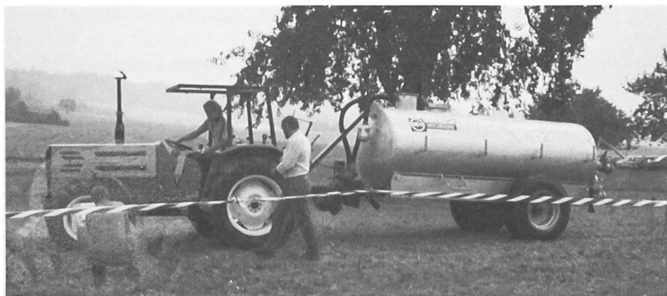
Schlupfmessung bei Traktor mit Druckfass.
