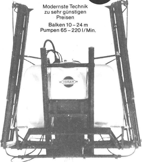
Hydraulische Höhenverstellung. Hydraulisches Zusammenklappen.
