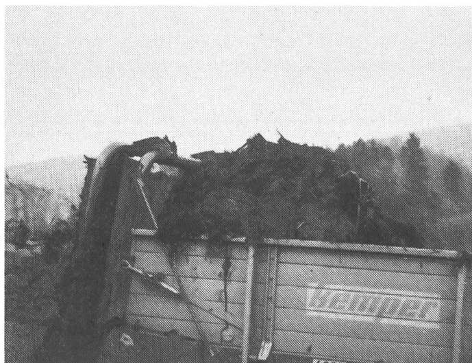
Abb. 4: Wenn der Mist höher als die Streuwalzen oder sogar höher als der Rahmen geladen ist, ...
