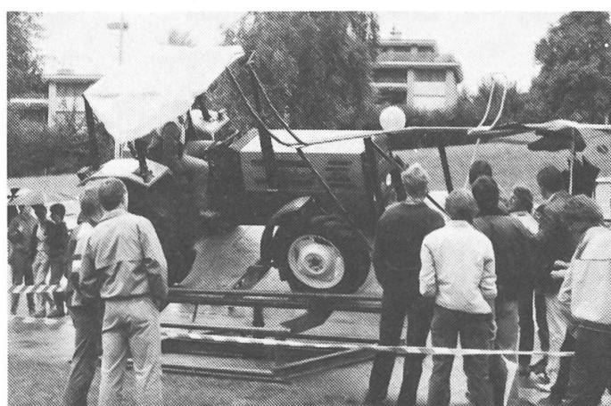
Wer den Ball auf der Kippbühne der Gleitbahn fixieren konnte, hatte das Ziel erreicht. Die Kippbühne wurde über das eingebaute Zusatzsteuerventil der Traktorhydraulik abgetrieben.
