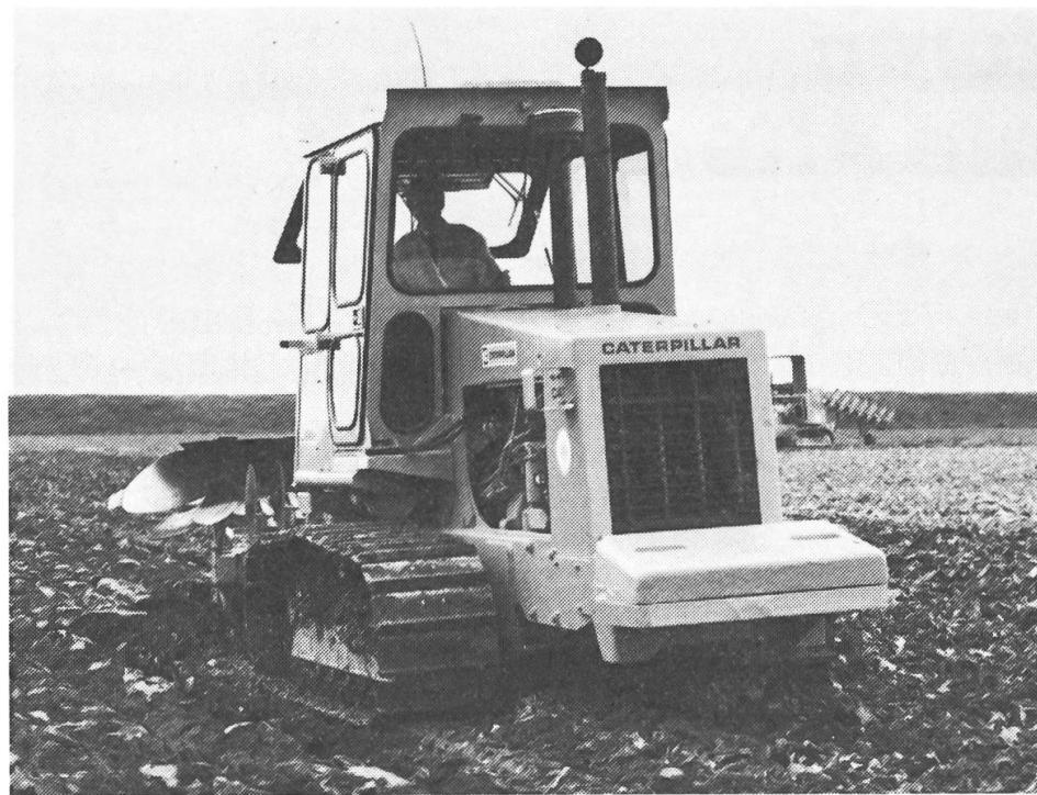
*Trotz geringstem Bodendruck – 0,3 bis 0,6 kp/cm<sup>2</sup> – und besserer Zugkraft werden die Raupentraktoren auf schweizerischen Ackerbaubetrieben auch in Zukunft kaum eine grosse Verbreitung finden.*
