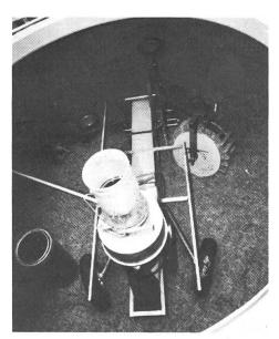
Hochleistungs-Silofräsen TAURUS zur vollautomatischen Entnahme von Mais, CCM-Silage, Kolben-
