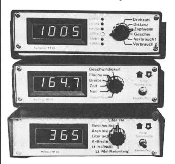
Ob Traktorleistungsmesser oder Arenzähler oder Spritzmengen-Kontrollgerät – erfolgreiche Landwirte bedienen sich dieser profitablen Instrumente.
