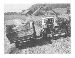
holen. Kein Korn bleibt ganz und wird unverdaut ausgeschieden! Zum Häckslen von Grünmais wird der Kornprozessor werkzeuglos ausgeschwenkt – kein umständliches Entspannen und Abnehmen von Keilriemen.
