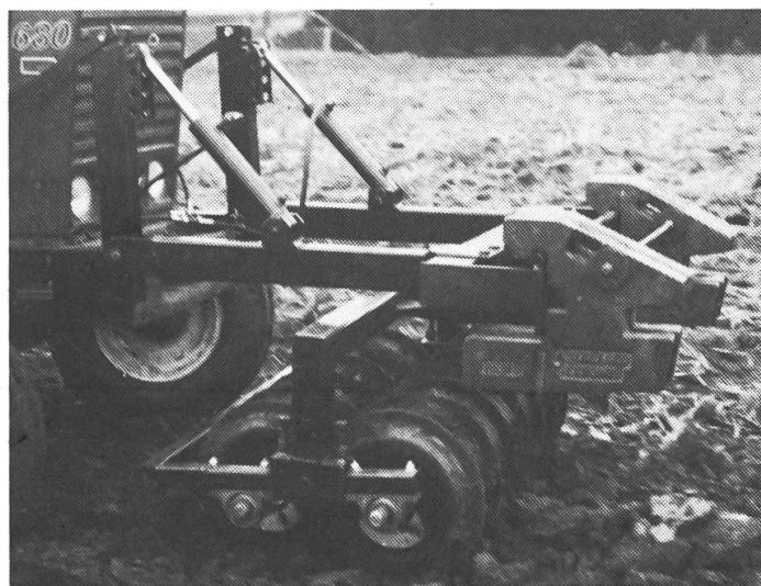
4: Front-Rückverfestiger aus zwei Packerwalzen. Dieses neue System soll eine besonders gute Zerkleinerungswirkung auf die Schollen haben.
