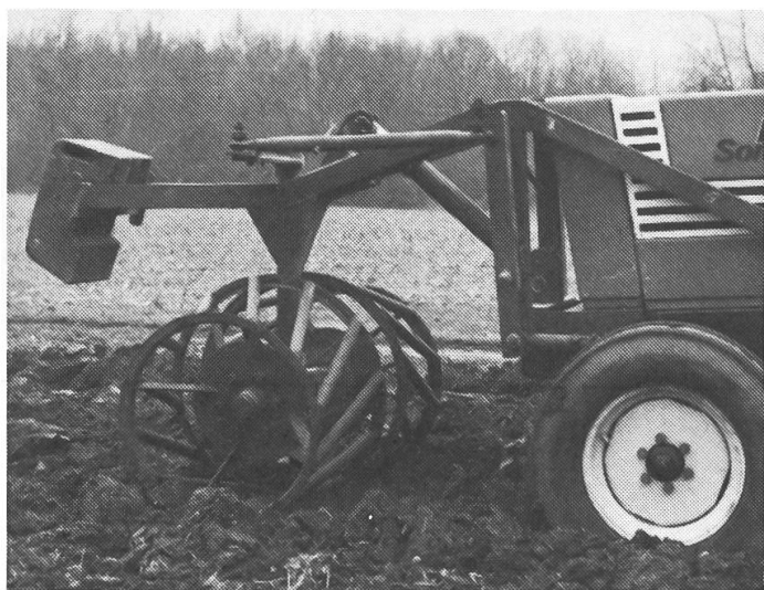
3: Stabwalze mit versetzt angeordneten Stäben, um die Reinigung zu vereinfachen.
