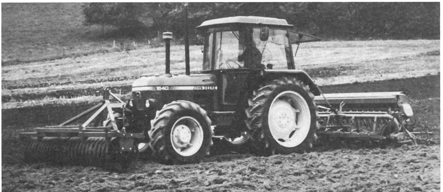
1: Die Arbeitsqualität der Spiralwalze ist fast gleich gut wie die der Stabwalze. Auf lehmigen Böden ist bisweilen die Rückverfestigung ungenügend. Sowohl Spiralwalze als auch Stabwalze sind widerstandsfähiger gegen Verschleiss und billiger als die Pneu-Rückverfestiger.
