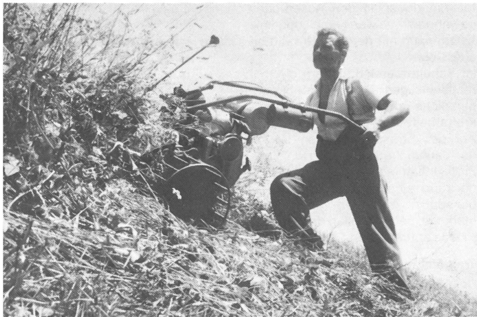
6: Die leichten wendigen Bergmäher ermöglichten das mechanische Mähen bis über 80% Neigung.
