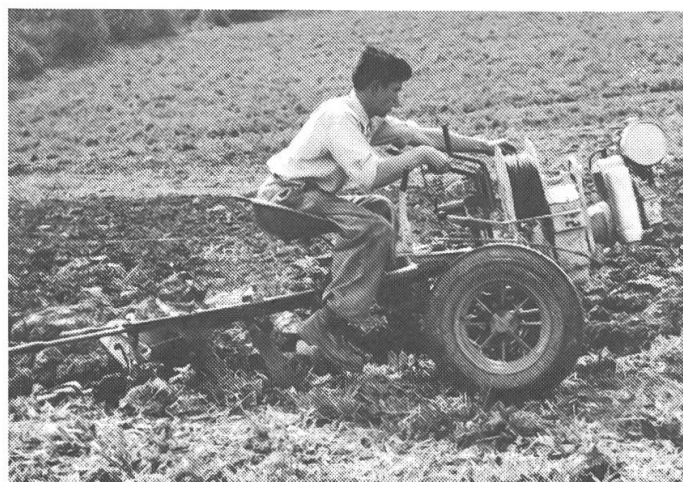
5: Langjährige Bemühungen um die Vereinfachung des Hangackerbaus führten durch das Seilzugverfahren mittels Seilspillwinde zu brauchbaren Lösungen.
