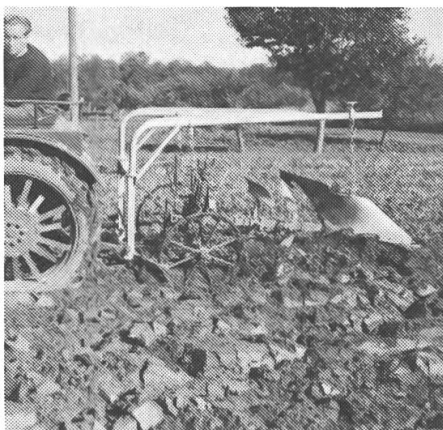
1: Von verschiedenen Pflugschmieden wurden an die Dreipunkthanhängung montierte Galgen hergestellt, was die Umwandlung des Selbsthalterpfluges in einen Einmannrehpflug ermöglichte.
