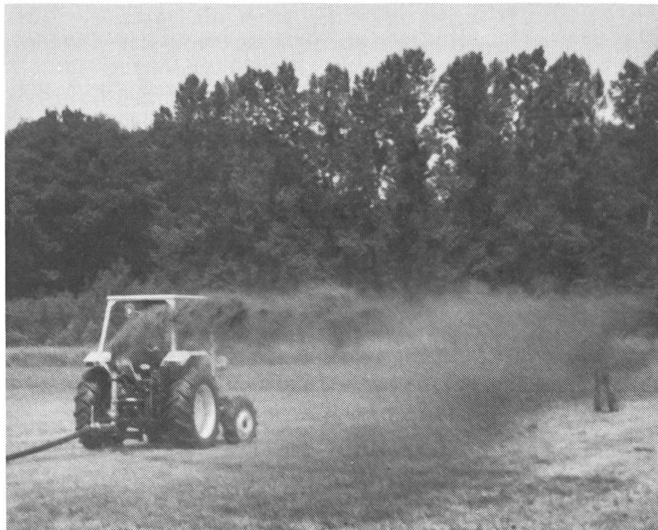
3: Die automatischen Gülleverteiler müssen optimal eingestellt sein. Der Güllestrahl soll beim Austritt ganz leicht nach oben gerichtet sein. Der Werfer soll auf beide Seiten gleich weit werfen.
