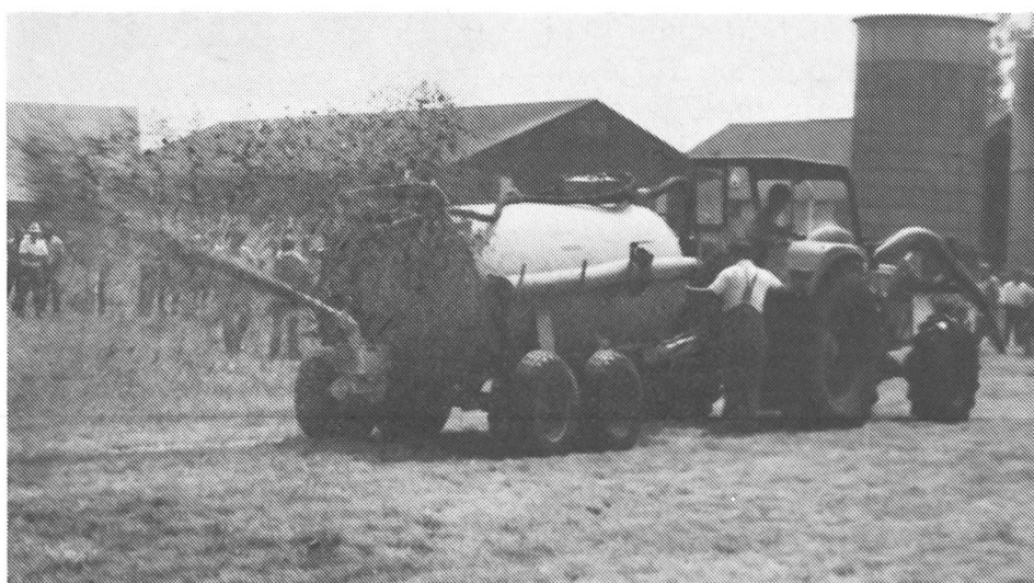
9: Für eine breitere und exaktere Verteilung der Gülle wurden spezielle, hydraulisch angetriebene Schwenkverteiler für Druck- und Pumpfässer entwickelt.
