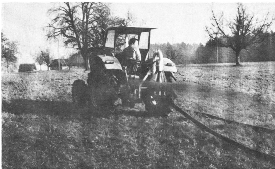
5: Der Gülleverteiler «JOVO» mit dem Prallteller bringt eine sehr gute Verteilung der Gülle. Er ist einfach gebaut und die Anschaffungskosten sind entsprechend niedrig. Die Arbeitsbreite beträgt 8 bis 9 m.
