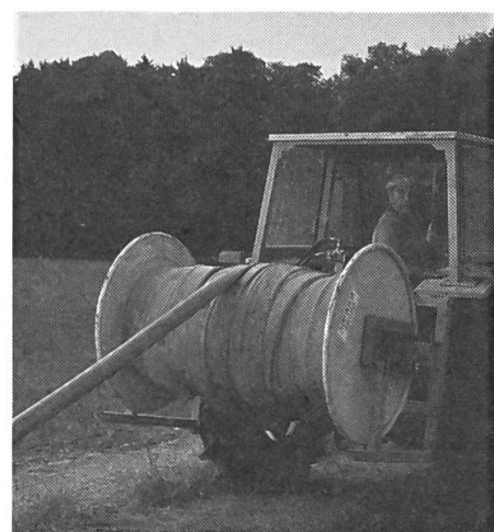
6: Die neuen PVC-Spezial-Hochdruckschläuche lassen sich auf einen kleineren Hasepel rollen. Ihr Eigengewicht ist viel kleiner als bei Polyäthylenrohren. Es besteht jedoch die Gefahr des Verwickelns.
