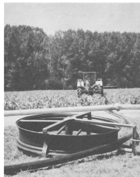
8: Probleme mit der Schlauchführung können mit einer Umlenkrolle vermieden werden. Diese Führungsrolle wurde aus einer grossen Traktorfelge hergestellt.
