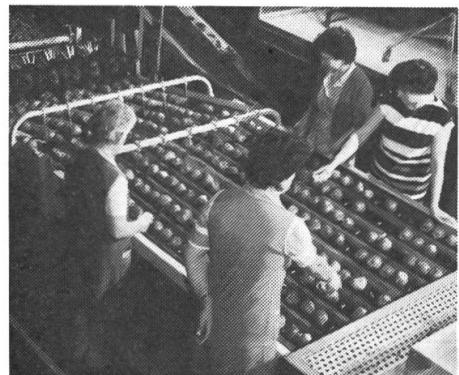
nicht mehr von Hand entfernt werden müssen. Darüber hinaus sorgt die elektronische Sortierung für die automatische Aufteilung auf die verschiedenen Ausgänge, so dass diese unabhängig von den prozentualen Anteilen der verschiedenen Güteklassen nicht blockiert werden. Dadurch wird gleichzeitig die Qualität der Früchte besser gewahrt.
