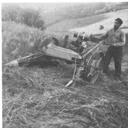
9. Motormäher mit Portalachse und seitlichem Mähmesserantrieb, ausgerüstet mit Schwadblechen.
