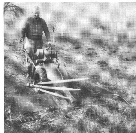
10. Die erste Eingrasvorrichtung bildete eine von der Radnabe aus angetriebene Holzgabel.
