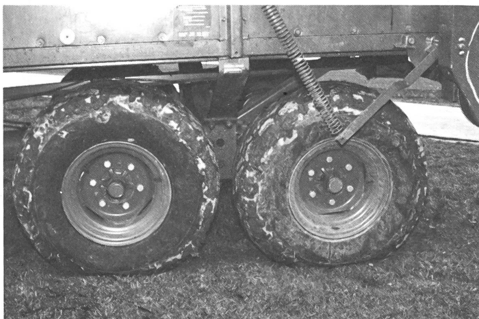
Miststreuer mit grösserer Kapazität erfordern eine vermehrte Beachtung der Bodendrücke. Der Mehrpreis für eine Doppelpendelachse oder eine Tandemachse, wie hier im Bild, dürfte sich in den meisten Fällen bezahlt machen.
