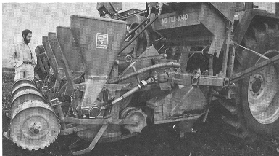
2: Hinter der Fräse wird mit einer Anpressrolle die gelockerte Erde rückverfestigt, bevor das Saatgut abgelegt wird.
