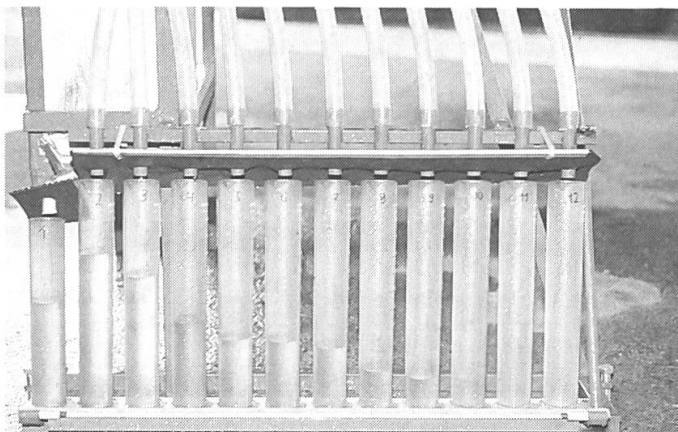
Abb.11: Vertikale Flüssigkeitsverteilung nach einer konventionellen Einstellung der Düsen und Luftleitbleche (links). Rechts: Versuch der Einstellung auf Bauformen mit einer linearen Abnahme der Blattfläche gegen die Baumspitze.
