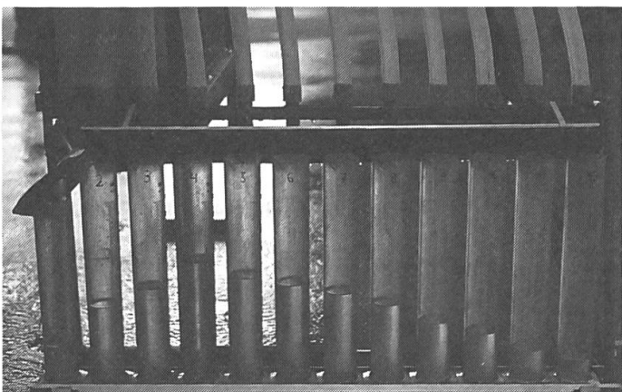
Abb.11: Vertikale Flüssigkeitsverteilung nach einer konventionellen Einstellung der Düsen und Luftleitbleche (links). Rechts: Versuch der Einstellung auf Bauformen mit einer linearen Abnahme der Blattfläche gegen die Baumspitze.
